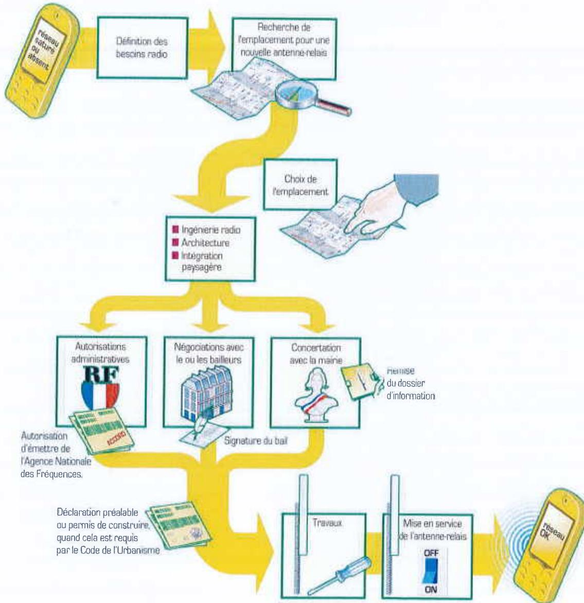
**Phases du déploiement d'une modification substantielle d'antenne-relais (à titre informatif) :**
