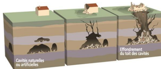
Le risque d'effondrement des cavités – DDT Yvelines
