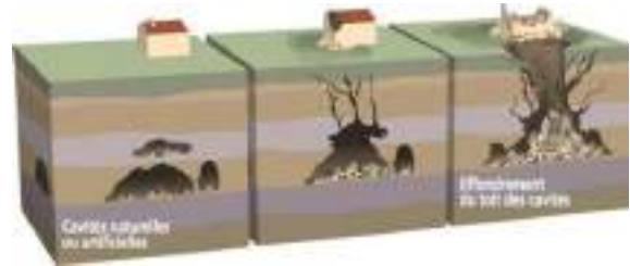
Le risque d'effondrement des cavités – DDT Yvelines
