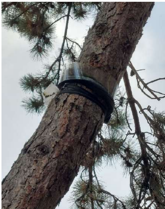
Pin n°115 : collerette d'éco-piège mal positionnée autour du tronc : bord supérieur de la collerette contre le tronc, collerette remplie de déchets et sangle trop serrée
